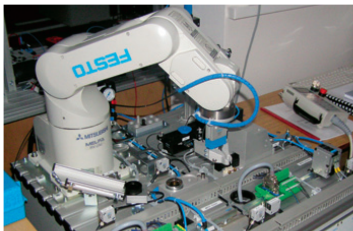
Robotické pracoviště tvořené robotem Mitsubishi a montážní stanicí
